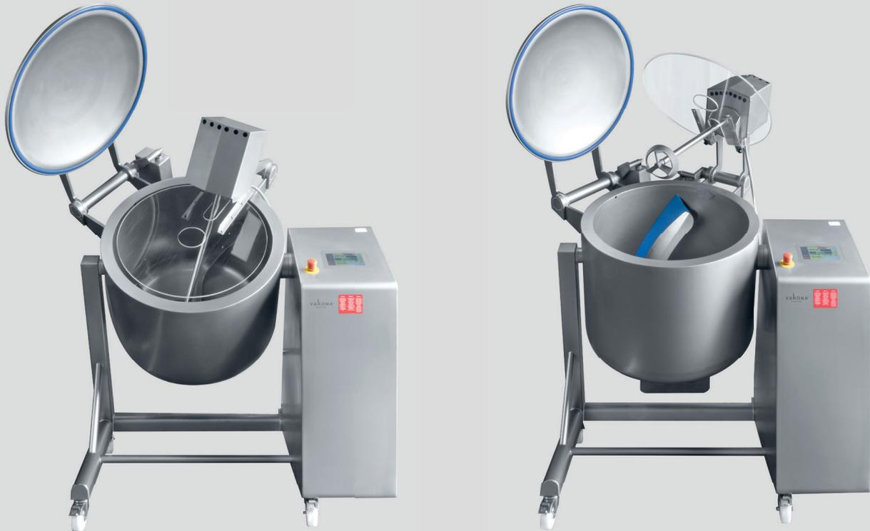
Speziell für den Einsatz in Großküchen und Kantinen wurde der Energiespar-Kühltumbler mit einem von oben einzuschwenkenden Turbomischer ausgestattet. Zusätzlich bietet er die Möglichkeit Wasser programmgesteuert über die Touch-Screen-Steuerung in den Behälter einzufüllen.
